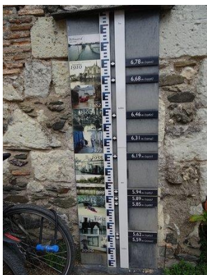
Echelle de crue sur la Loire
